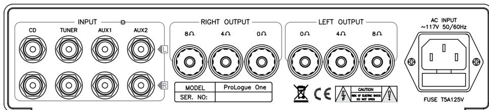
Sur le panneau arrière vous trouverez 4 entrées et une paire de borniers enceintes. Connecter le positif (+) de votre enceinte avec la valeur de la borne 4 ou 8 ohms qui se rapproche le plus de l'impédance moyenne de vos enceintes selon les spécifications du fabricant. Connecter le négatif (-) de votre enceinte avec la borne 0 ohm.
